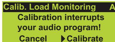
Auswahl von "Calibrate" startet die Kalibrierung und deren Fortschritt wird angezeigt. Die Kalibrierung kann durch Drücken des Encoders zu jedem Zeitpunkt abgebrochen und ggf. wieder neu gestartet werden.
