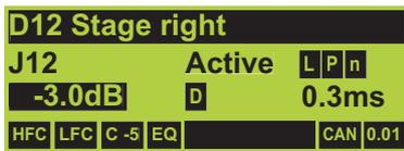
Fig. 15: D12 Input Monitoring, Anzeige aktiver Notch
