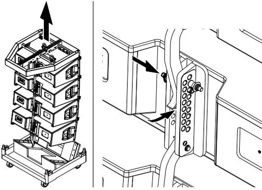
1. Heben Sie die Gruppe langsam aus dem Touring Cart heraus, bis alle Splay Links vollständig in die voreingestellten Locking Pins eingehakt sind.
