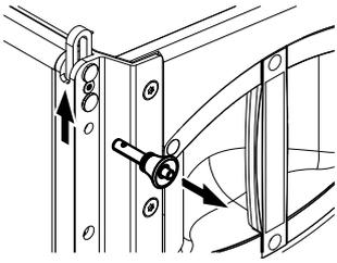
3. Lösen Sie die beiden Locking Pins auf der Vorderseite des obersten Lautsprechers.
