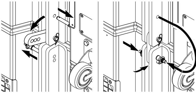
6. Lösen Sie die Locking Pins am hinteren Riggingstrang beider Lautsprecher.
