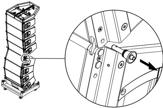
6. Senken Sie das Array langsam und gleichmäßig auf das Cart ab, bis die Front Links lastfrei sind.
