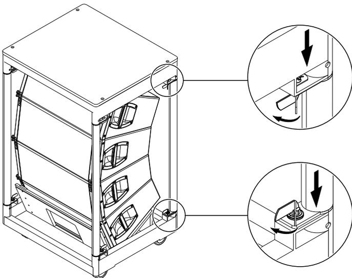
2. Stecken Sie die Verbindungsstangen in ihre Aufnahmen im Bodenfach und schließen Sie alle Camlocks.
