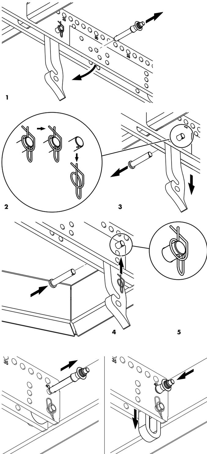
1. Lösen Sie den Locking Pin für den Splay Link in Parkposition und ziehen Sie den Pin heraus. Klappen Sie den Splay Link aus.
