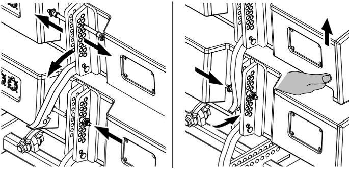
4. Lösen Sie auf der Rückseite die beiden Locking Pins für den Splay Link des oberen Lautsprechers.
