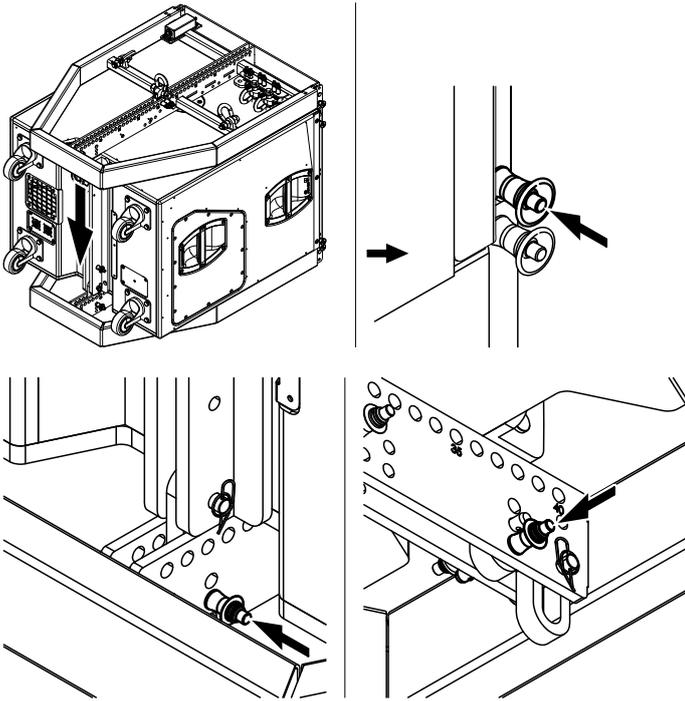
4. Senken Sie den Aufbau auf den Flugrahmen ab, sodass die Front Links in die vorderen Aufnahmen am Flugrahmen eingeführt sind und der Rear Link in die Mittelschiene des Flugrahmens einhakt.
