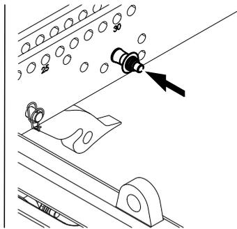
3. Lösen Sie den Locking Pin, der den Splay Link des Flugrahmens in seiner Parkposition hält.
